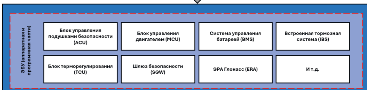
Упрощенная архитектура программно-определяемых ТС Simplified architecture of software-defined vehicles
